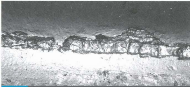
Rys. 2. Przykład dużych uszkodzeń bieźni i rozwalcowania jej krawędzi [9]
