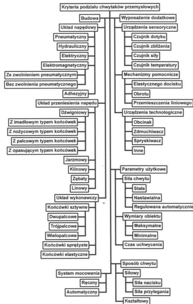
RYS. 2. Kryteria podziału chwytaków robotów przemysłowych
